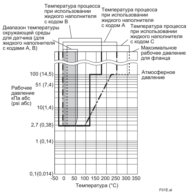
Рис. 1-1. Рабочее давление и температура процесса (Жидкий наполнитель: силиконовое масло для общего и высокотемпературного применения)
